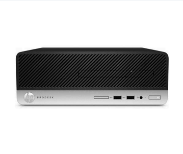
Vista frontal: unidad óptica DVD, 2× USB 3.0 y salida de audio
